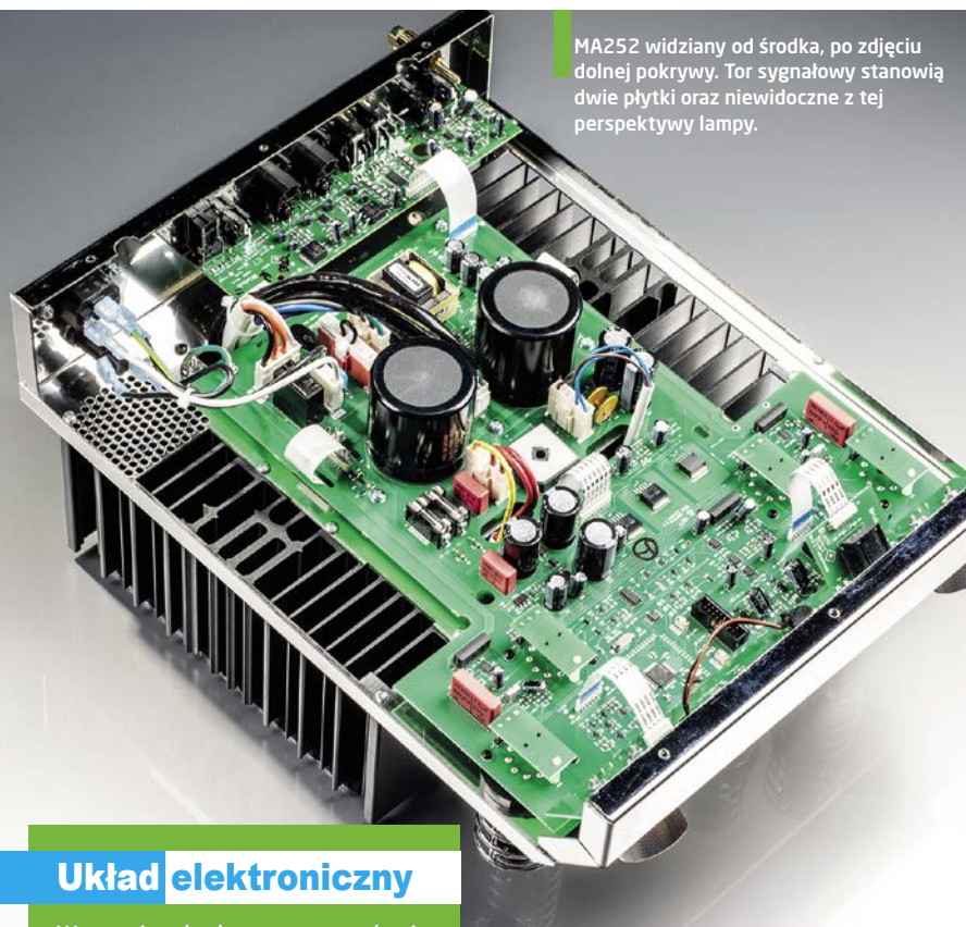
Sekcja wejściowa została wykonana w montażu powierzchniowym. Do regulacji poziomu służy układ NJW 1194.
